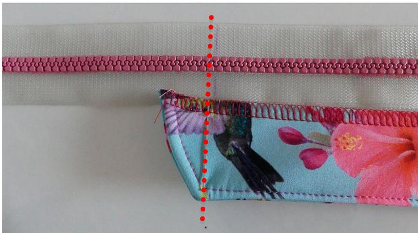
Jetzt kannst Du die RV Zähnnchen mit einer Zange vorsichtig bis zur Markierung entfernen oder abwickeln. Achtung, der Zipper kann jetzt ganz leicht herausrutschen, hier aufpassen dass das nicht geschieht. Schneide den RV dann ca. 3 cm hinter der Markierung ab.
